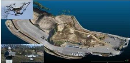
ドローン等による写真測量等により、短時間で面的(高密度)な3次元測量を実施。
